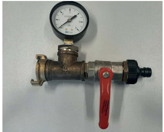
Bild 2: Einfache Konstruktion zur Druckermittlung mit Manometer und tränkseitigem Absperhahn
